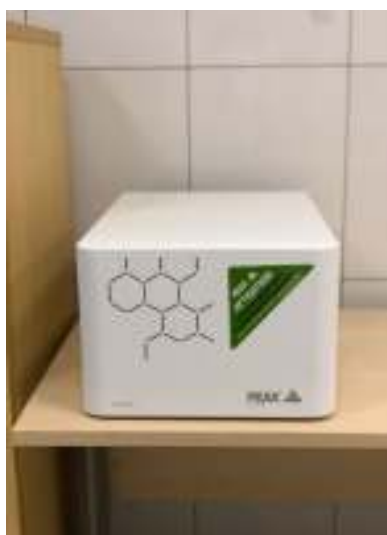
Figura 3 – Gerador de Nitrogênio.
