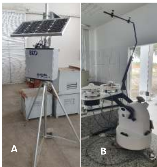
Figura 9 – Estações Solarimétricas. A - Estação Estática. B - Estação Tracker.
